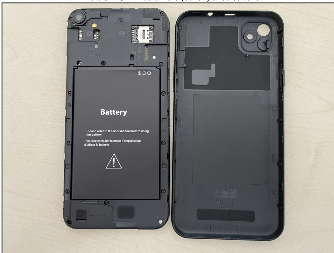
Photo 5: EST – vue arrière (ouvert) avec batterie
