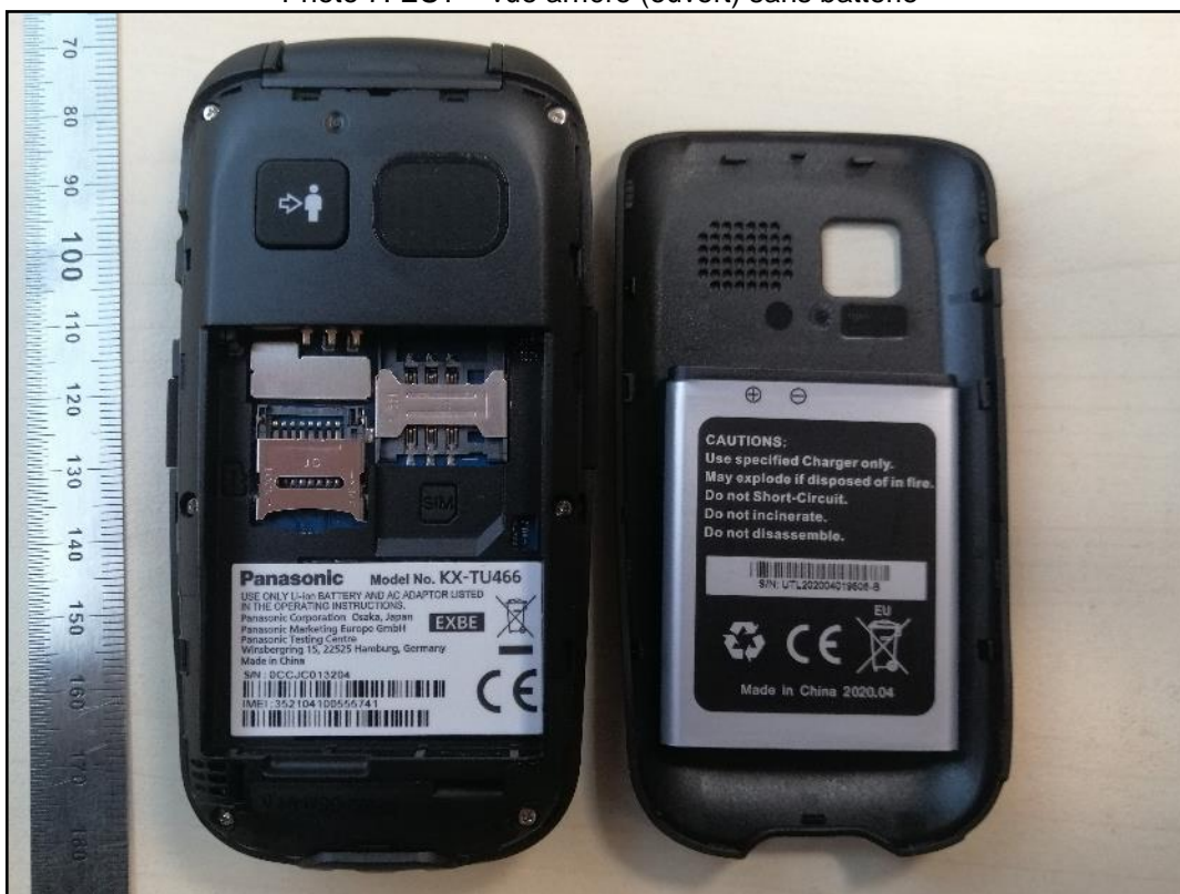
Photo 7: EST – vue arrière (ouvert) sans batterie
