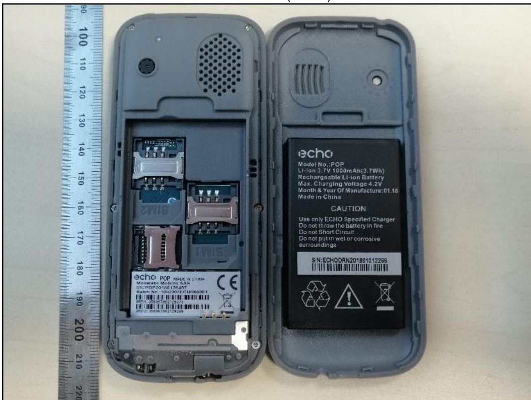
Photo 6: EST – vue arrière (ouvert) sans batterie
