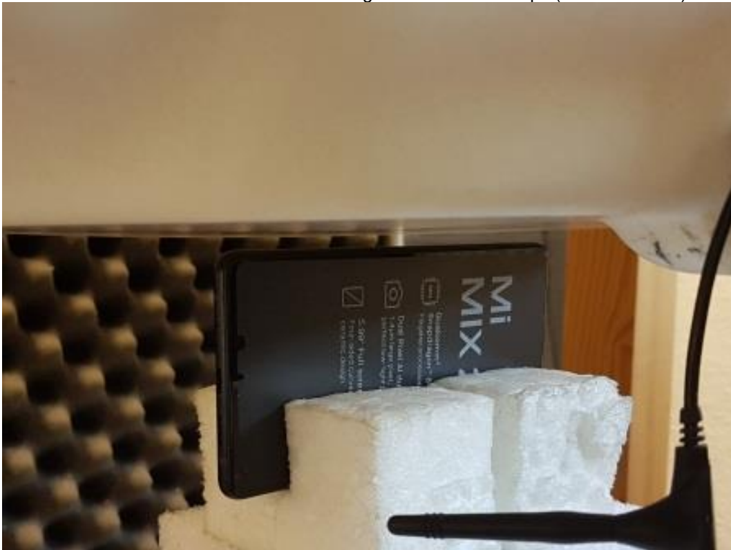
Photo 10: Position d'essai face du côté droite contre le corps (distance 5 mm)
