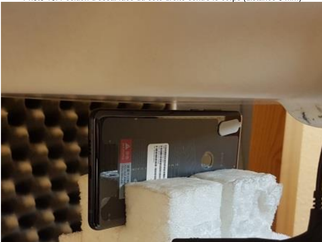
Photo 10: Position d'essai face du côté droite contre le corps (distance 5 mm)
