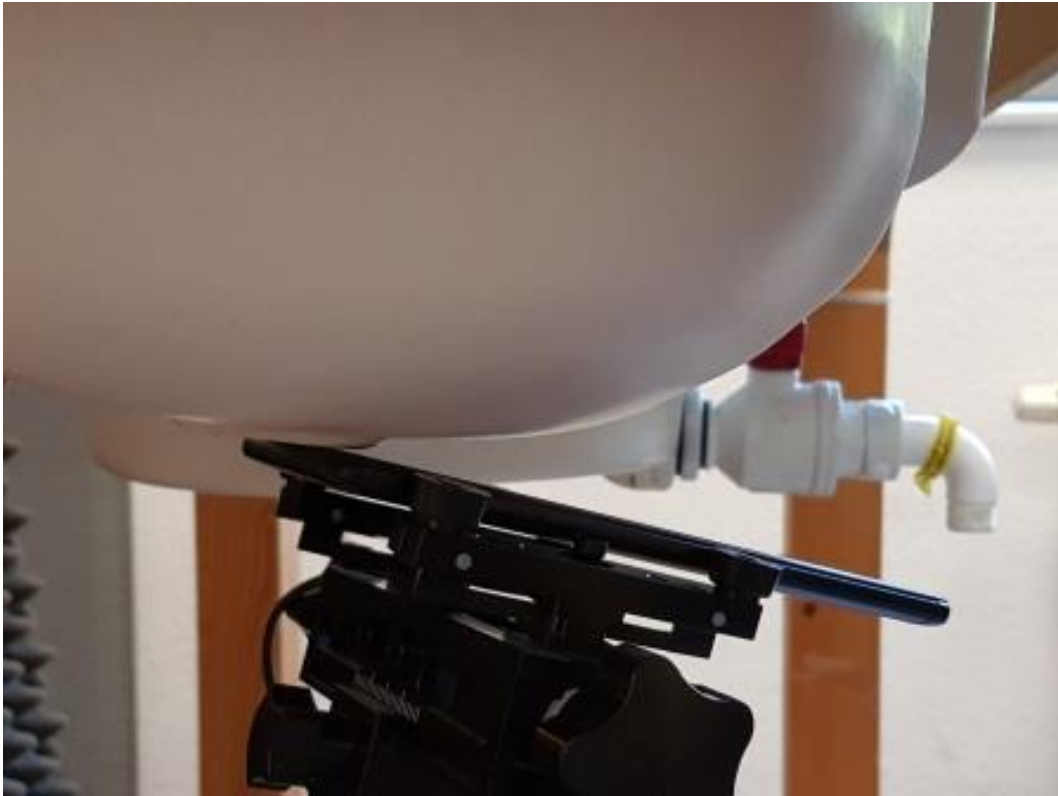
Photo 15: Position d'essai main droite, incliné 15°
