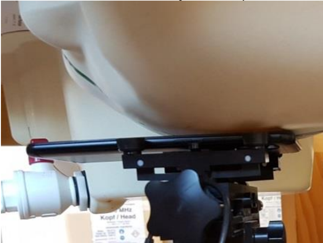
Photo 8: Position d'essai main gauche, contre la joue
