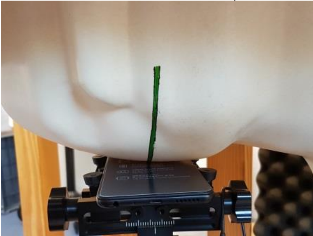
Photo 12: Position d'essai main droite, contre la joue
