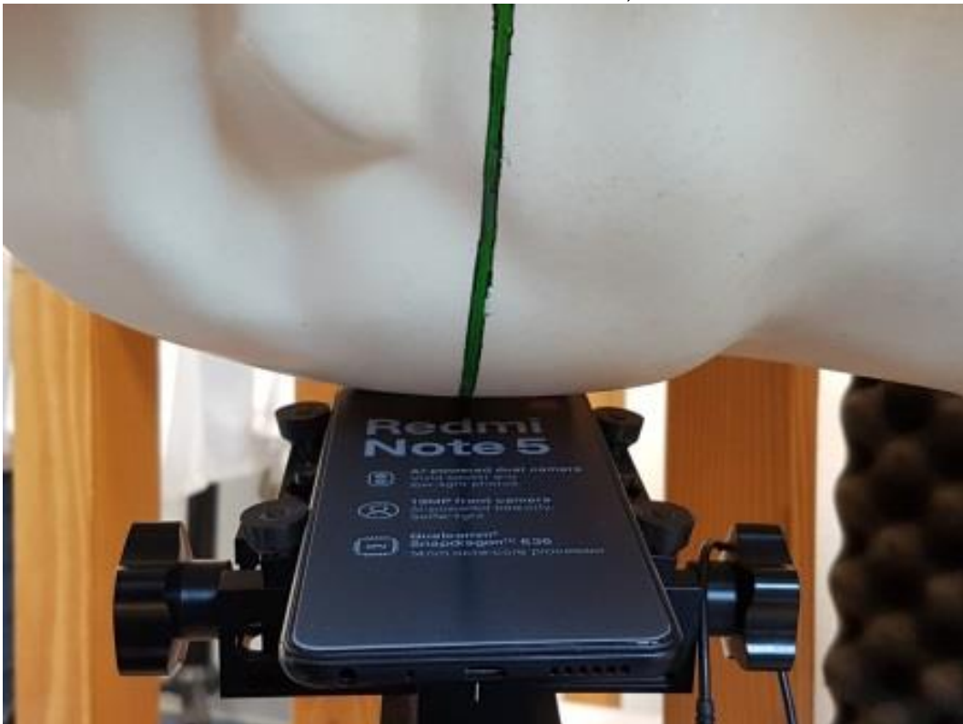
Photo 14: Position d'essai main droite, incliné 15°
