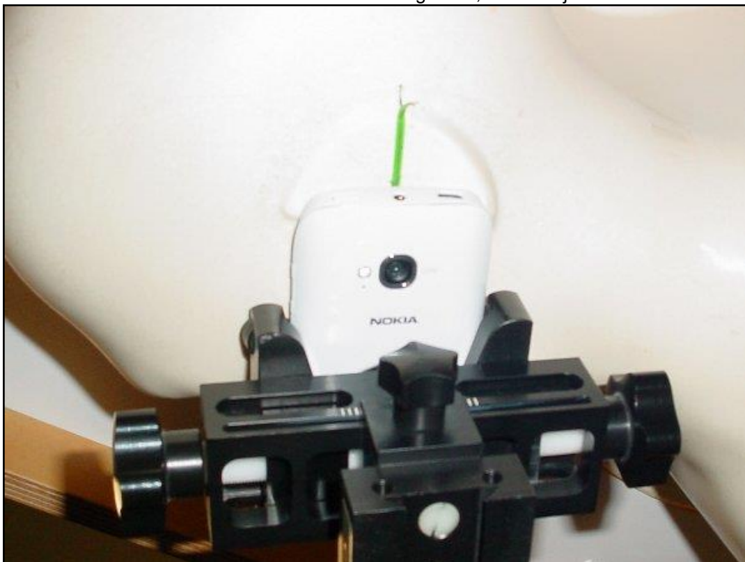
Photo 10: Position d'essai main gauche, contre la joue
