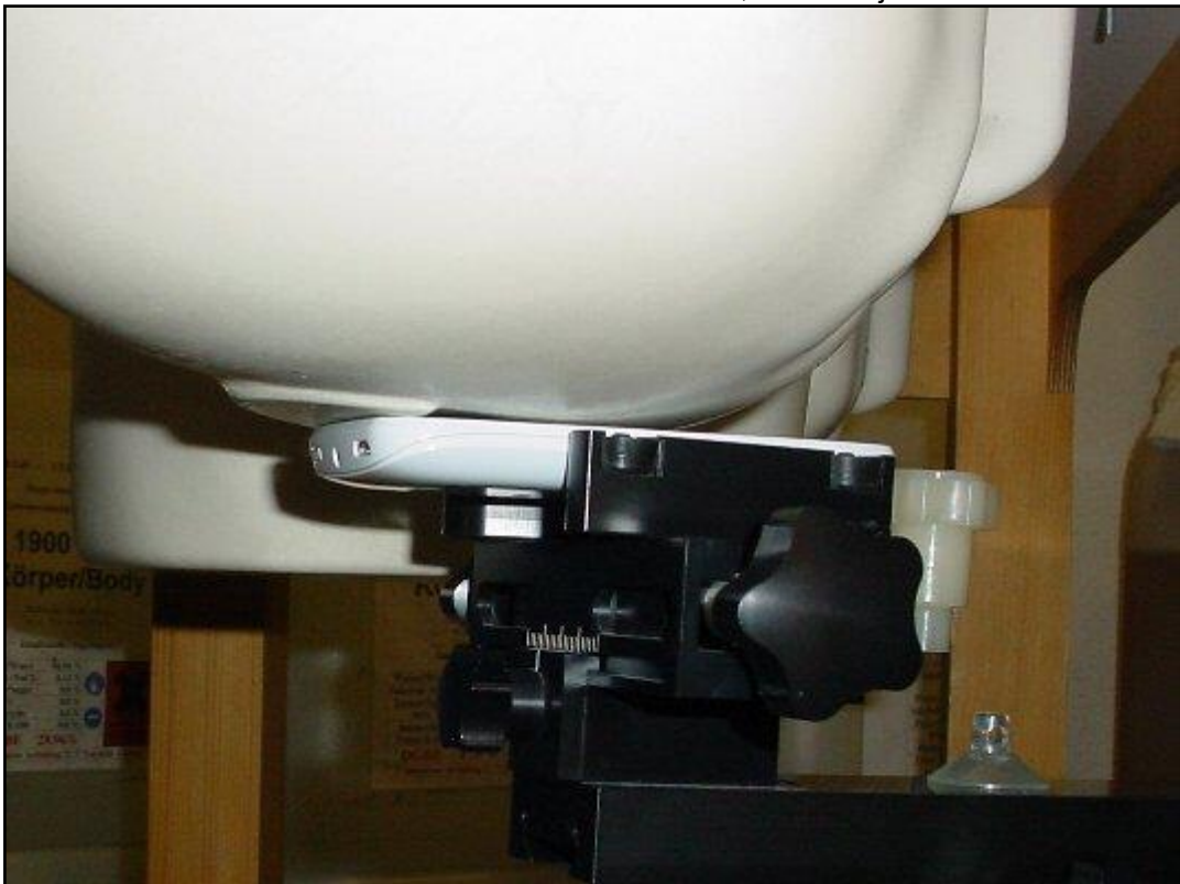
Photo 14: Position d'essai main droite, contre la joue
