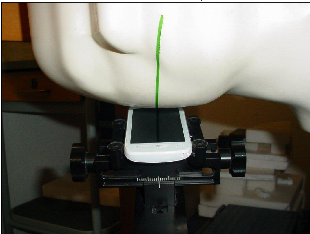
Photo 16: Position d'essai main droite, incliné 15°
