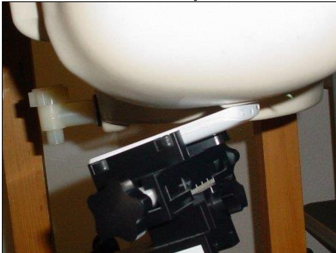
Photo 12: Position d'essai main gauche, incliné 15°
