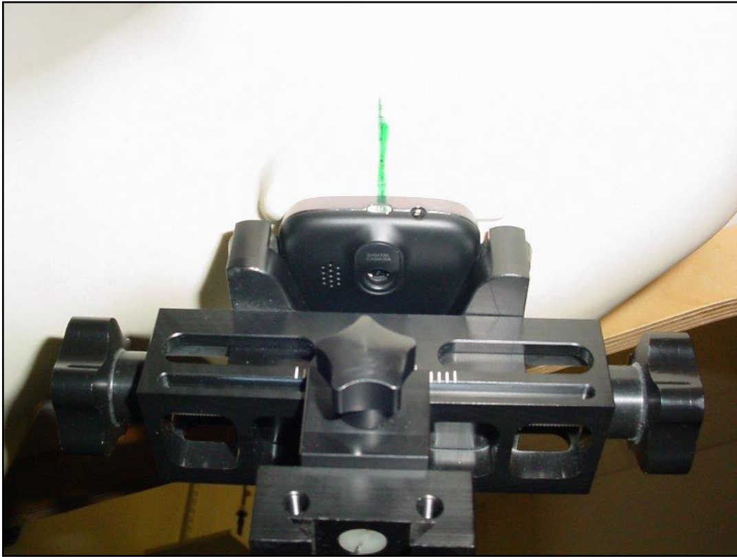
Photo 16: Position d'essai main droite, incliné 15°
