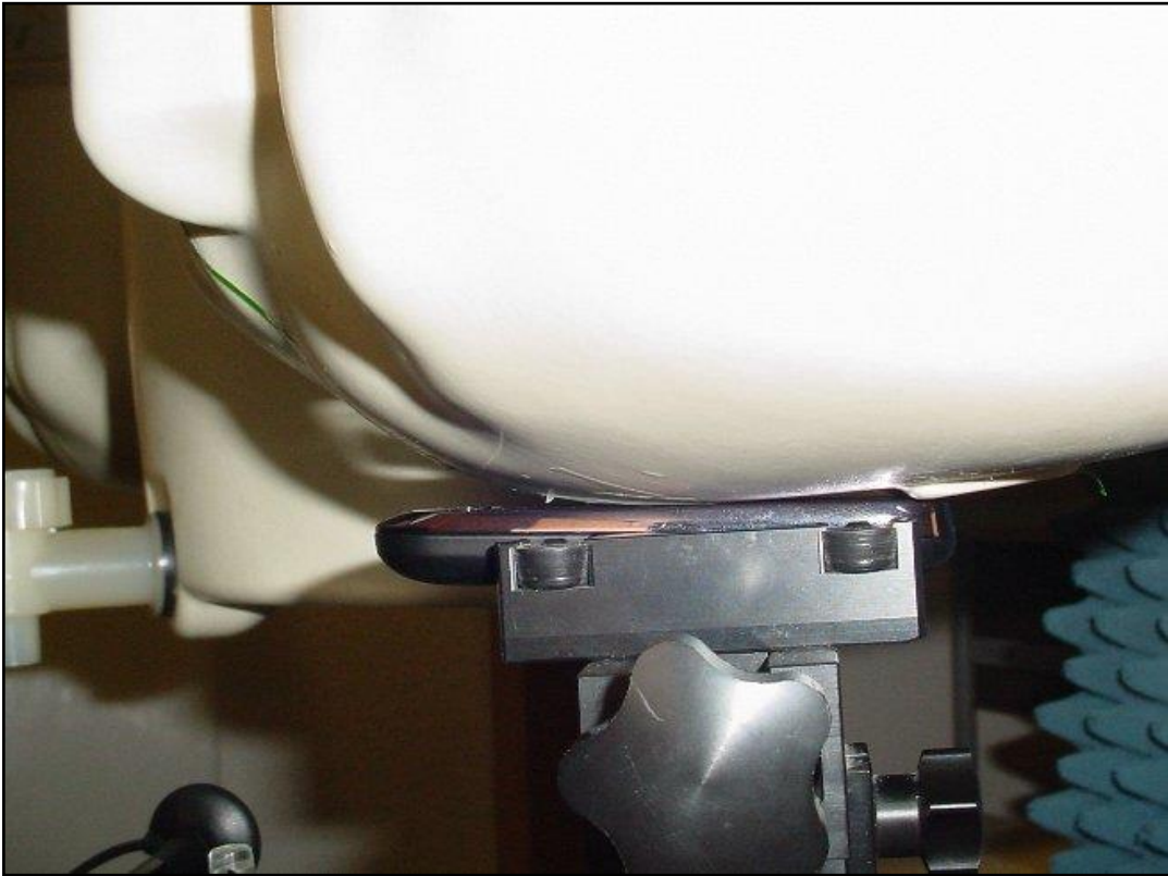
Photo 10: Position d'essai main gauche, contre la joue
