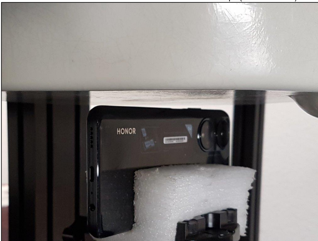
Photo 9: Position d'essai face du côté droite contre le corps (distance 5 mm)
