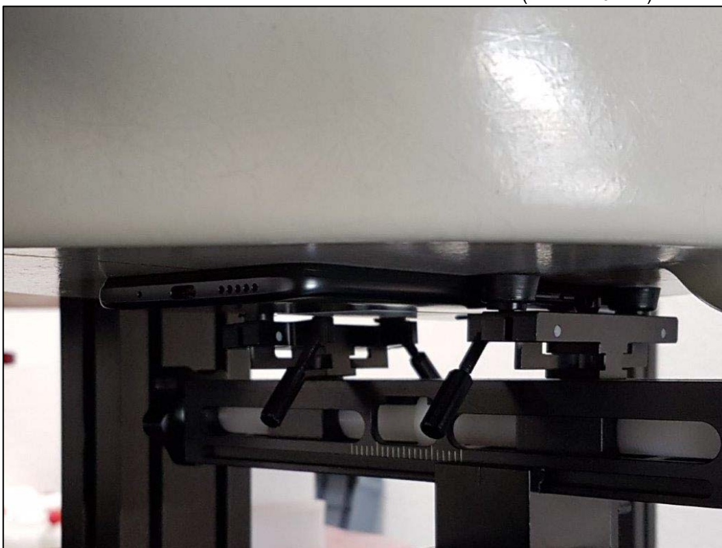
Photo 8: Position d'essai face arrière contre le membre (distance 0 mm)
