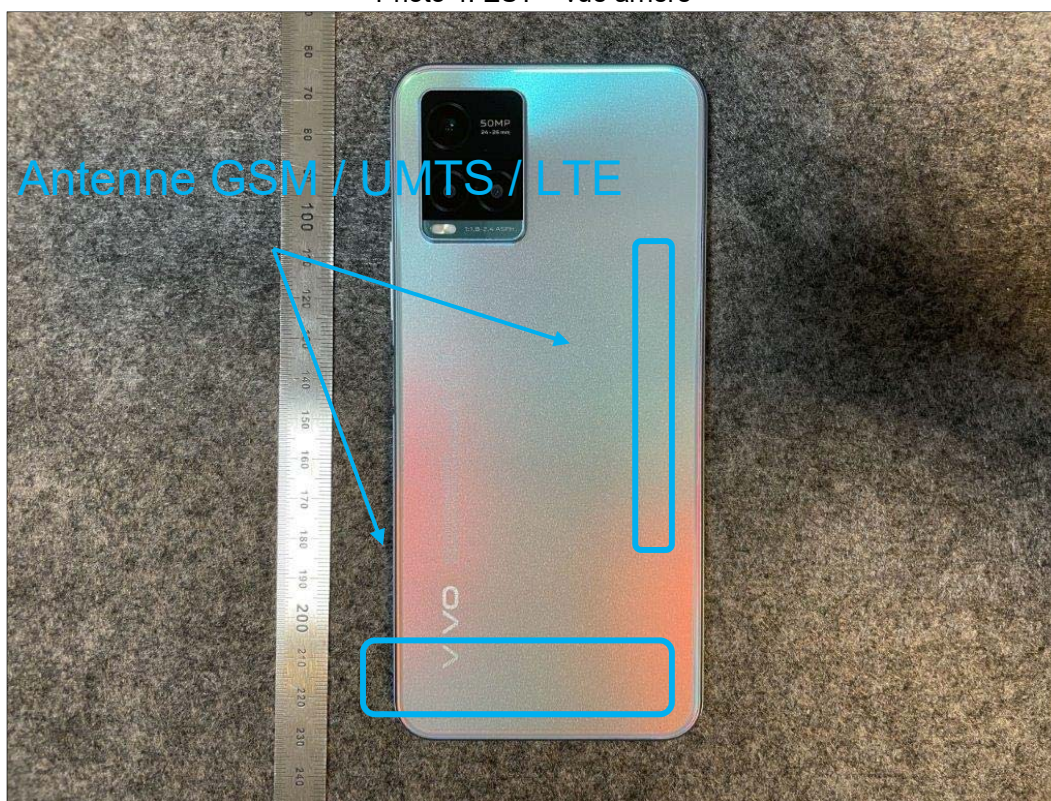
Photo 4: EST – vue arrière
