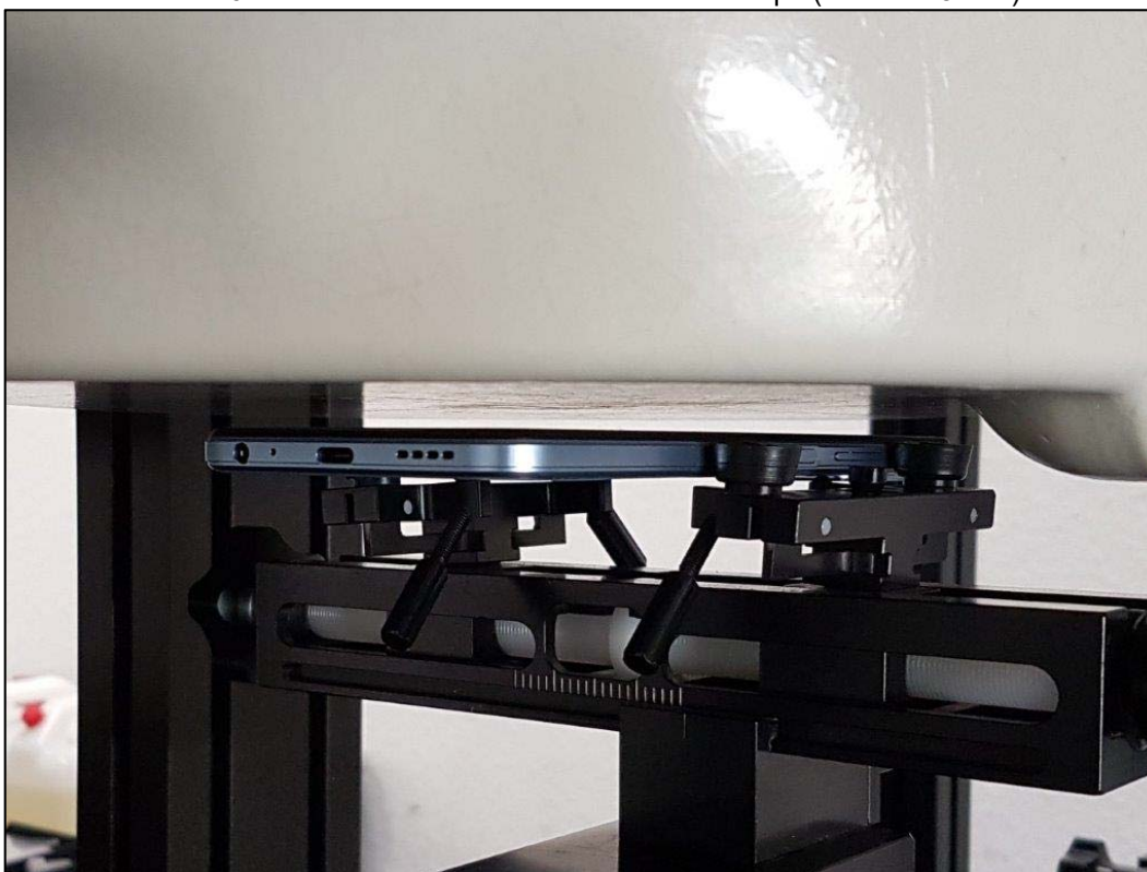
Photo 7: Position d'essai face arrière contre le corps (distance 5 mm)
