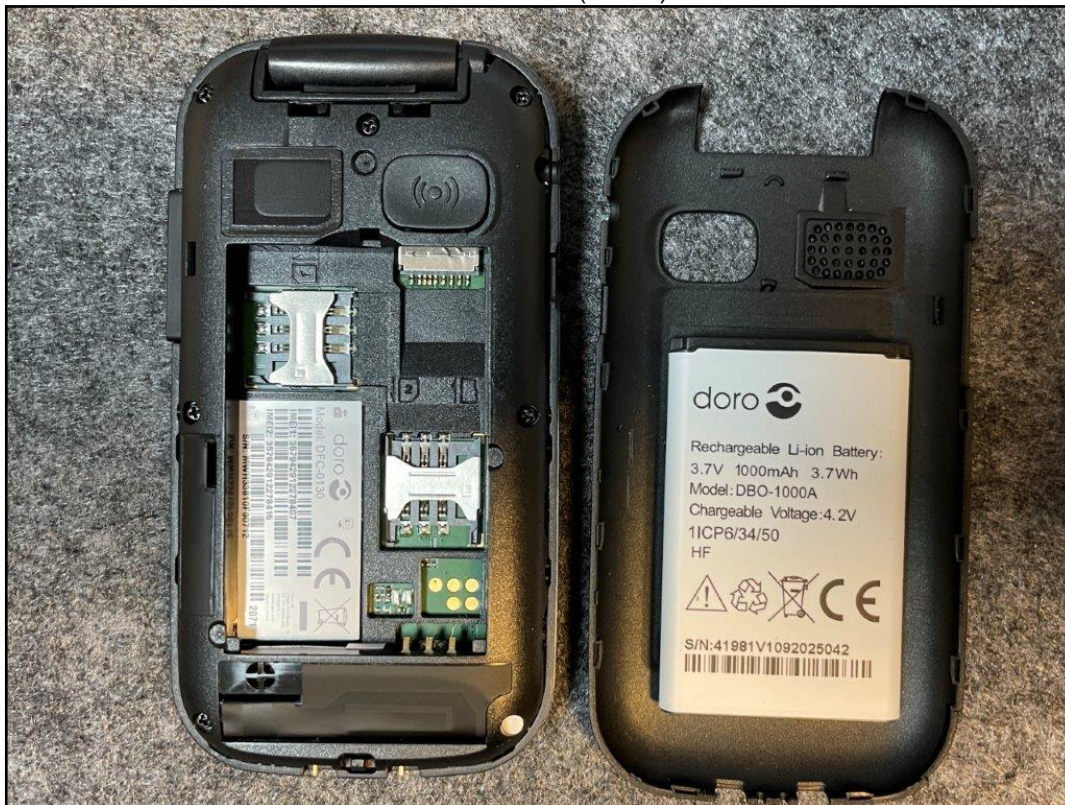
Photo 7: EST – vue arrière (ouvert) sans batterie
