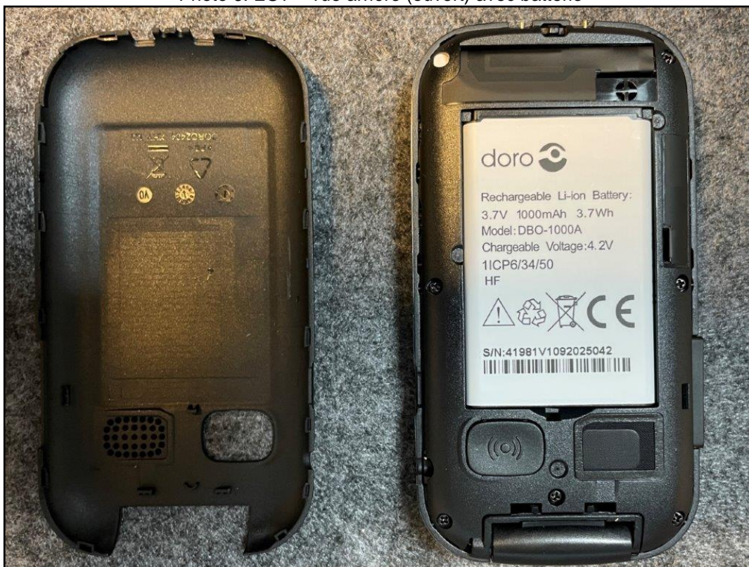
Photo 6: EST – vue arrière (ouvert) avec batterie
