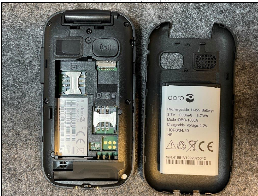
Photo 7: EST – vue arrière (ouvert) sans batterie
