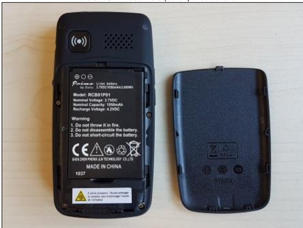
Photo 6: EST – vue arrière (ouvert) avec batterie
