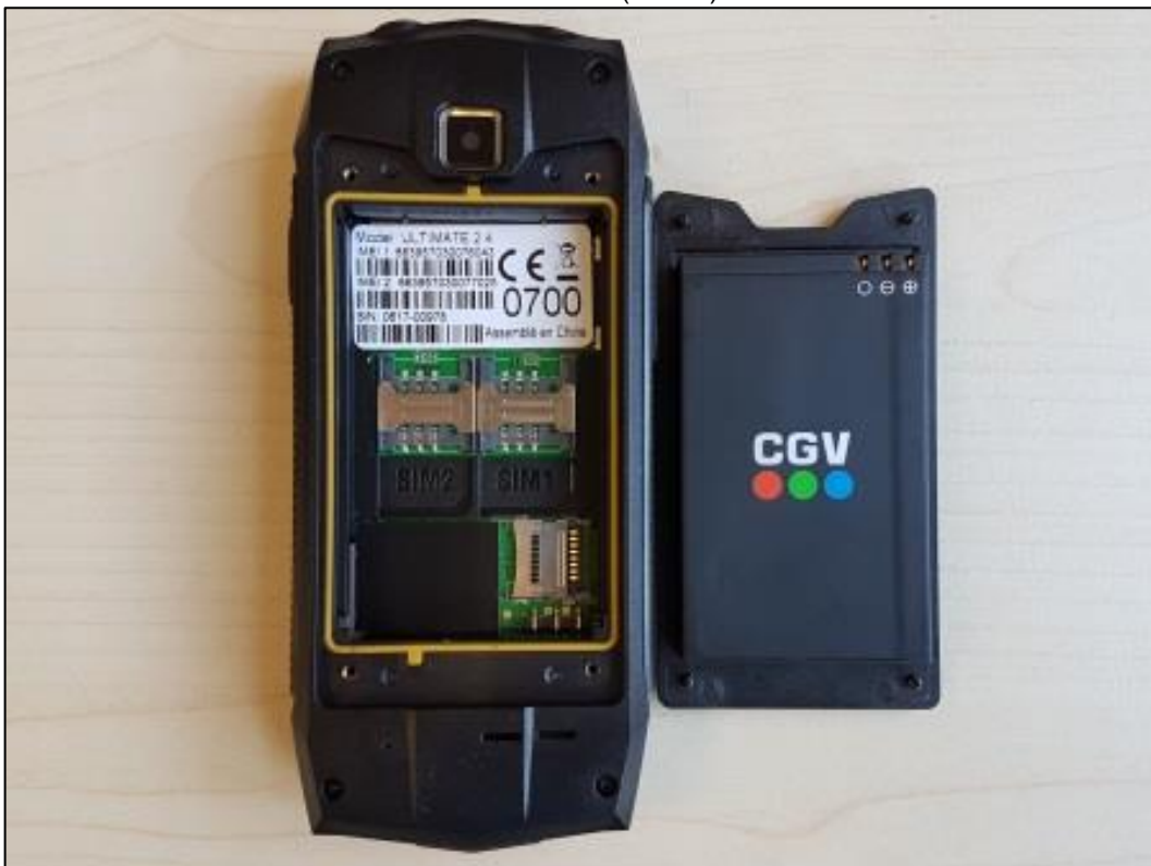
Photo 6: EST – vue arrière (ouvert) sans batterie
