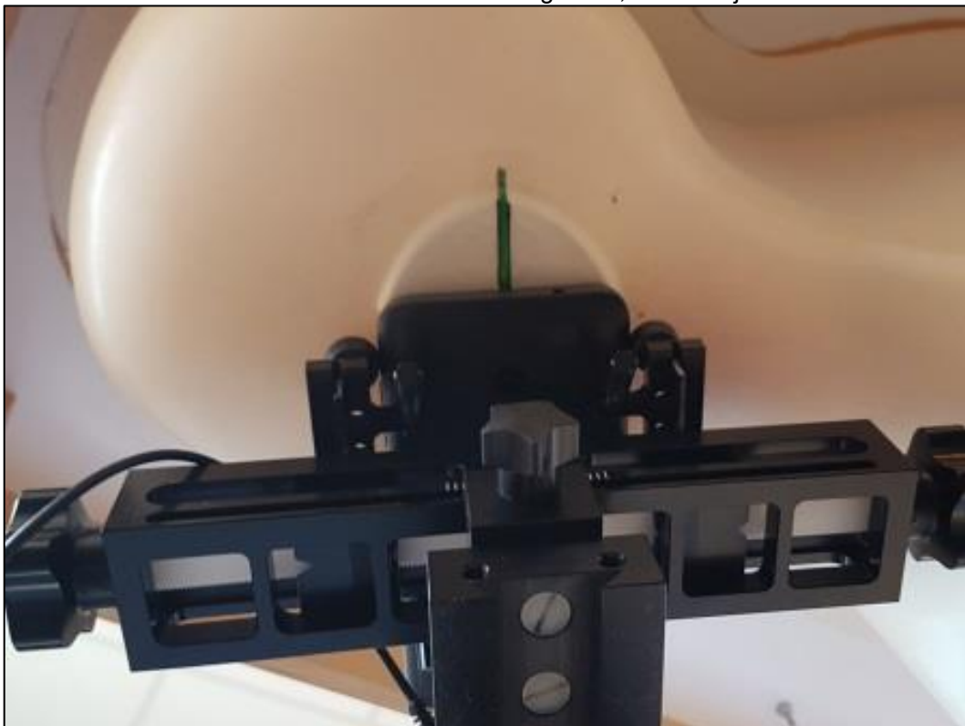
Photo 10: Position d'essai main gauche, contre la joue
