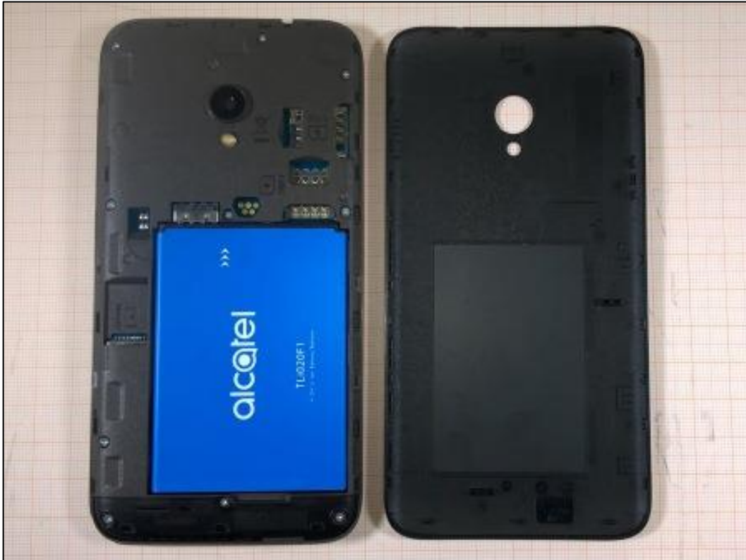
Photo 5: EST – vue arrière (ouvert) avec batterie
