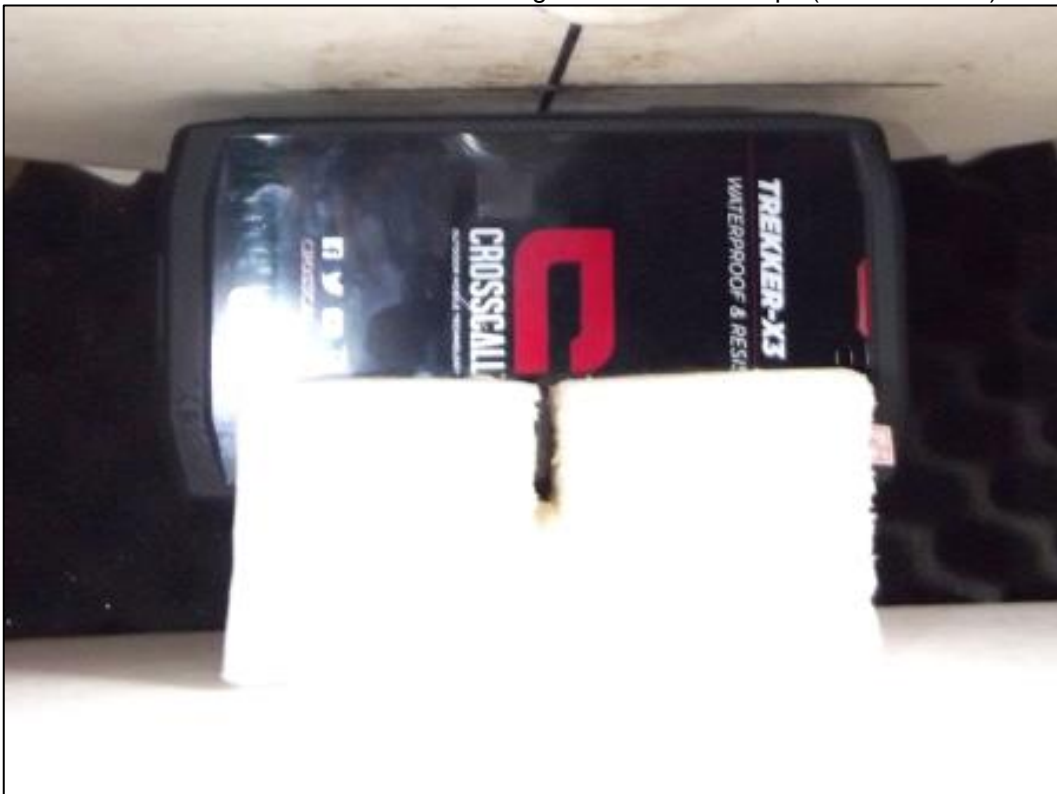
Photo 10: Position d'essai face du côté gauche contre le corps (distance 5 mm)
