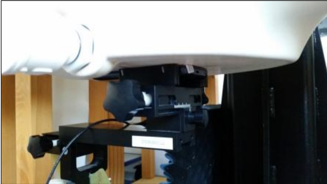
Photo 9: Position d'essai face avant contre le corps (distance 0 mm)
