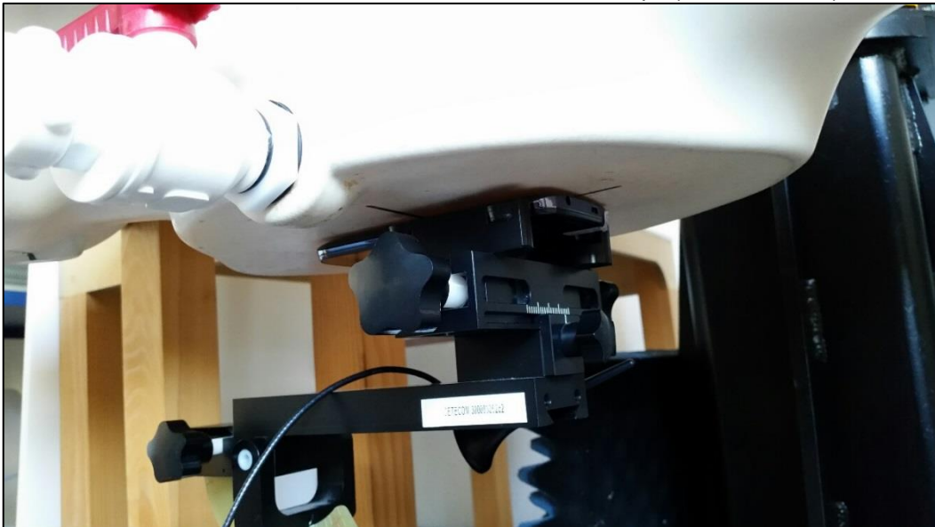
Photo 10: Position d'essai face arrière contre le corps (distance 0 mm)
