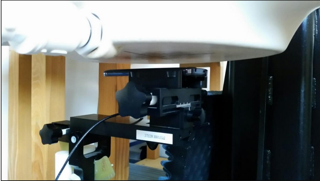
Photo 11: Position d'essai face arrière contre le corps (distance 15 mm)
