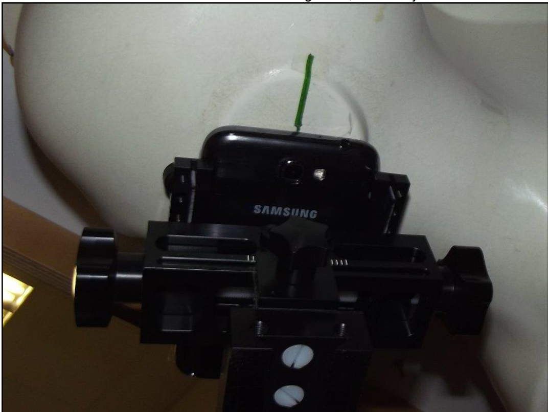
Photo 10: Position d'essai main gauche, contre la joue
