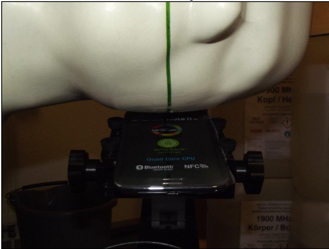
Photo 12: Position d'essai main gauche, incliné 15°
