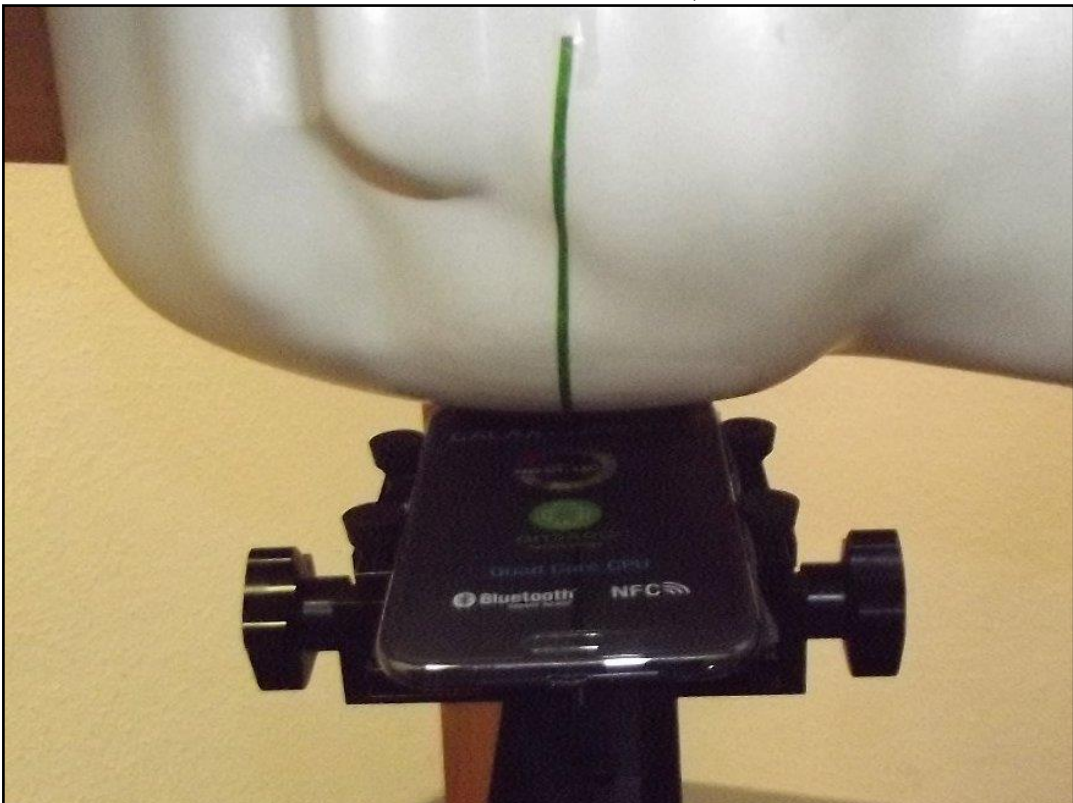
Photo 16: Position d'essai main droite, incliné 15°
