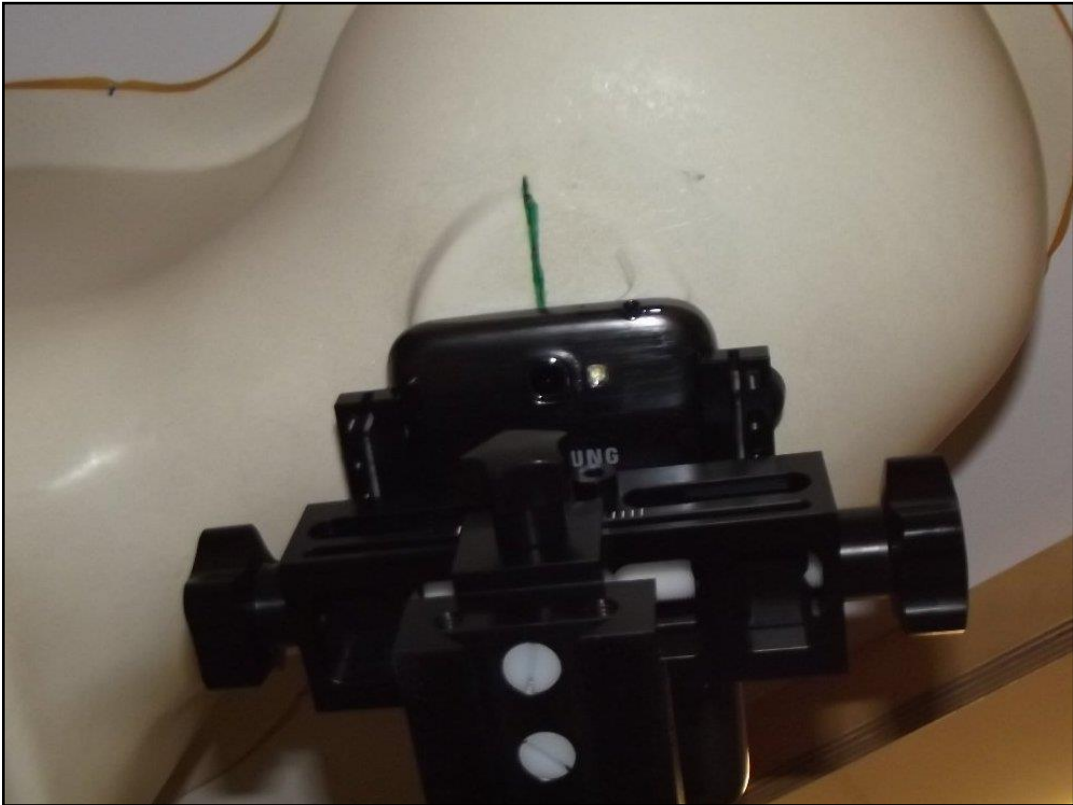
Photo 16: Position d'essai main droite, incliné 15°
