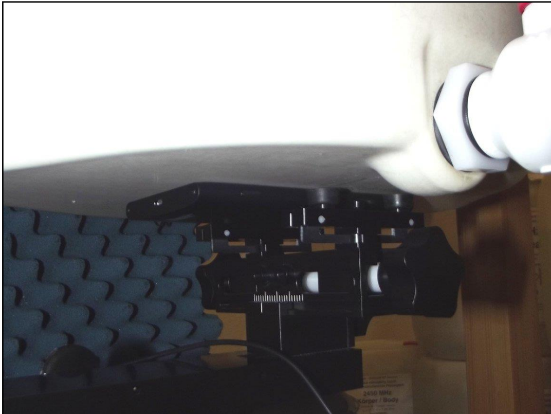
Photo 5: Position d'essai face avant contre le corps (distance 0 mm)
