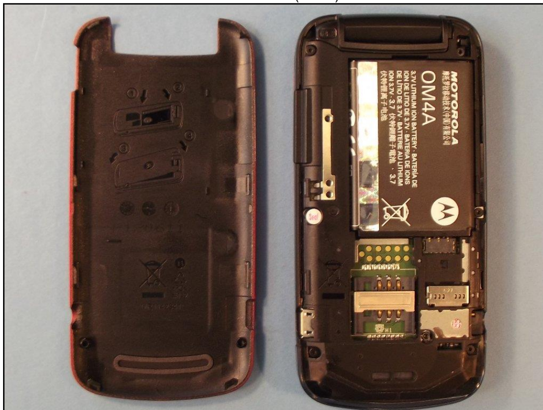
Photo 6: EST – vue arrière (ouvert) avec batterie
