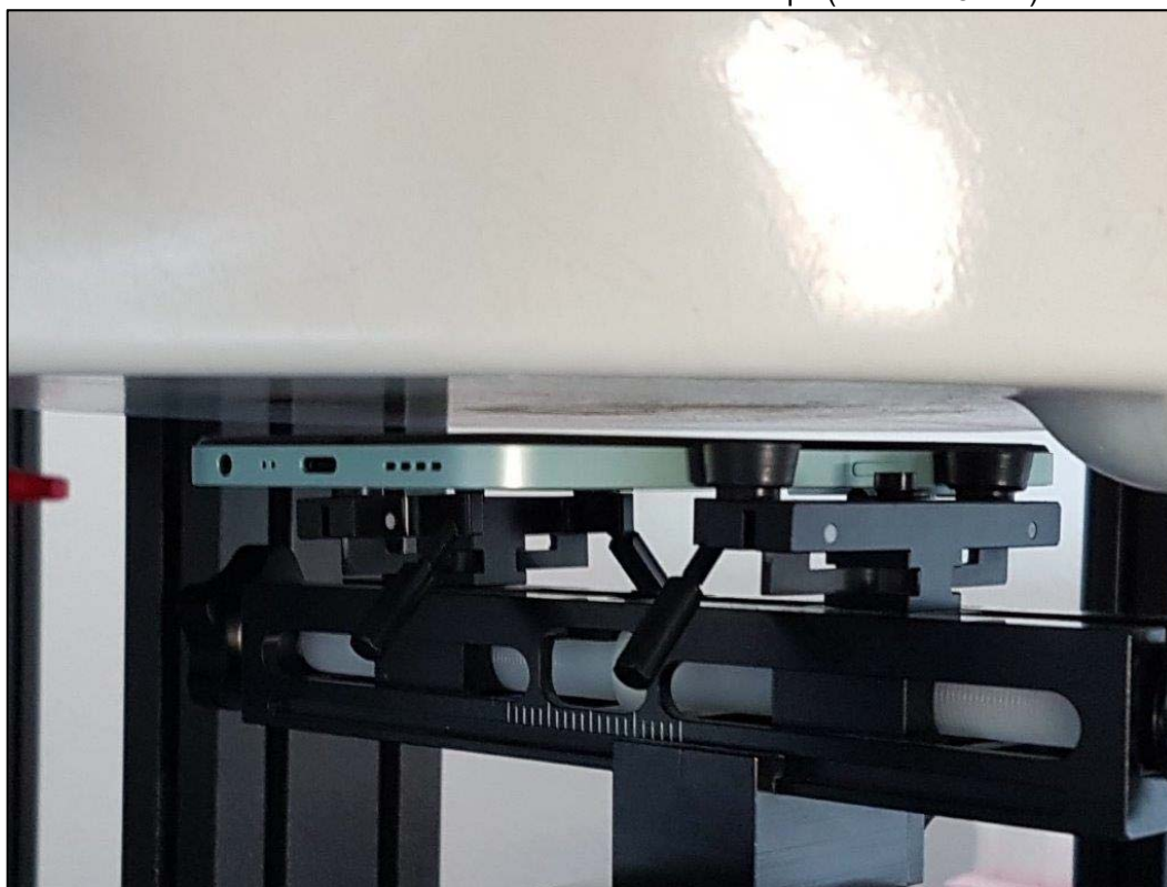
Photo 8: Position d'essai face arrière contre le corps (distance 5 mm)
