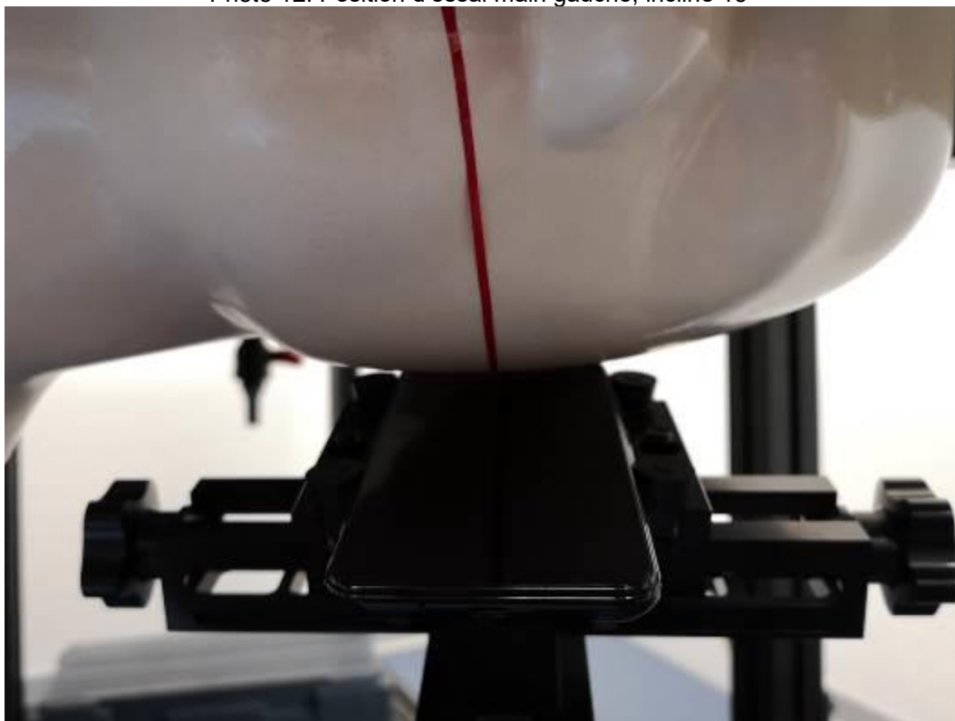
Photo 12: Position d'essai main gauche, incliné 15°
