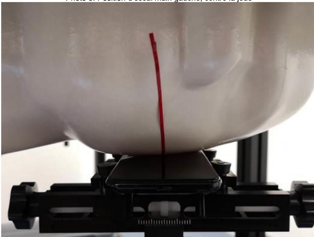
Photo 10: Position d'essai main gauche, contre la joue
