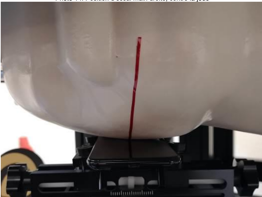
Photo 14: Position d'essai main droite, contre la joue
