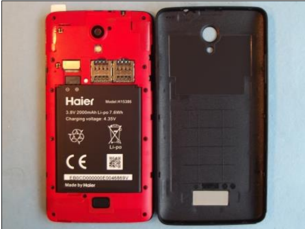
Photo 5: EST – vue arrière (ouvert) avec batterie
