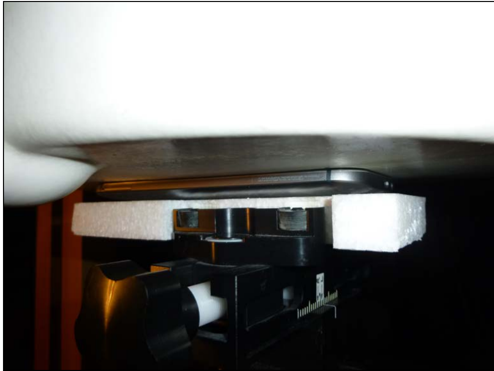
Fig. 15: Face avant à 0cm du fantôme SAM
