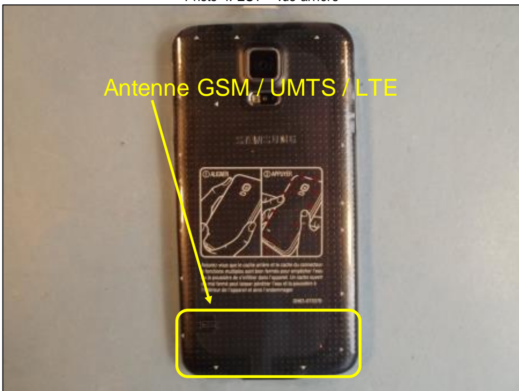
Photo 4: EST – vue arrière
