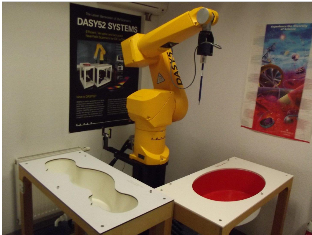
Photo 1: Banc d'essai DASY 5
