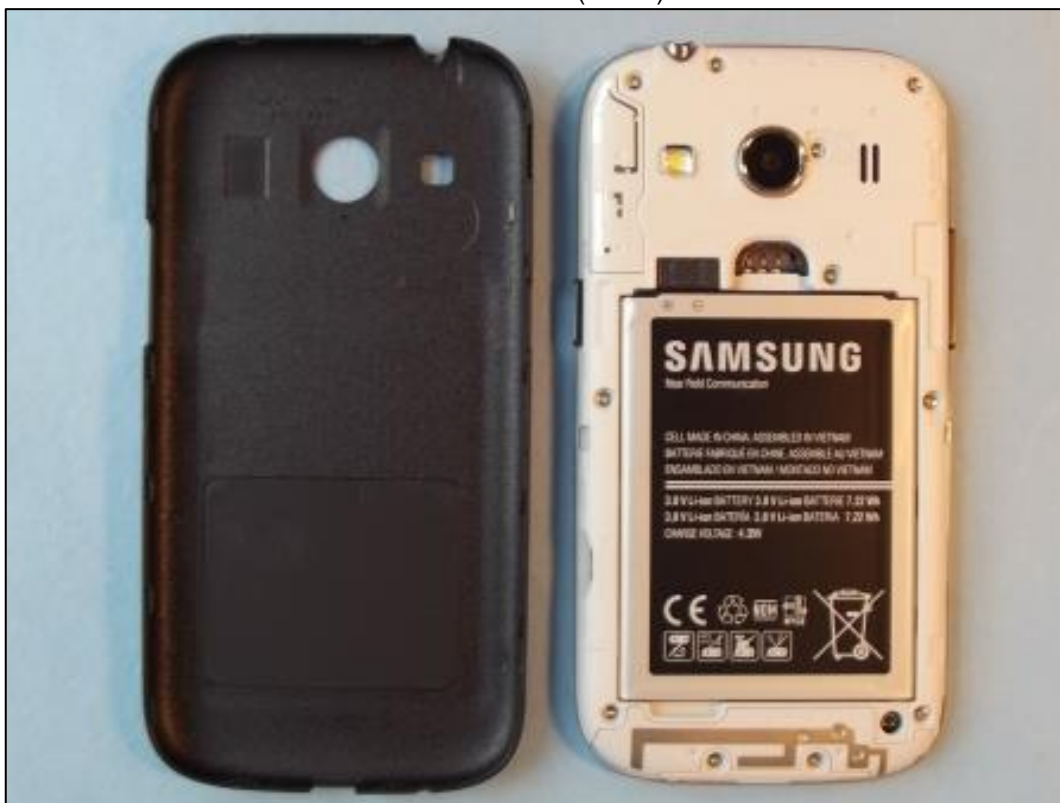
Photo 5: EST – vue arrière (ouvert) avec batterie
