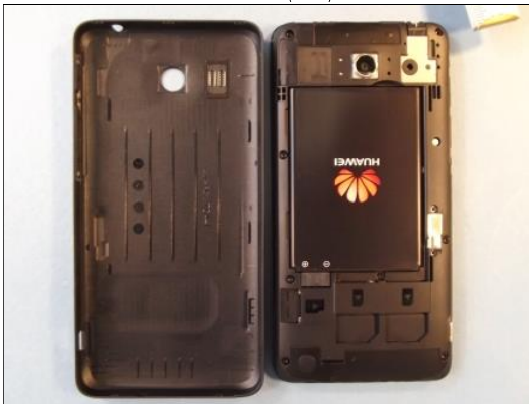
Photo 5: EST – vue arrière (ouvert) avec batterie
