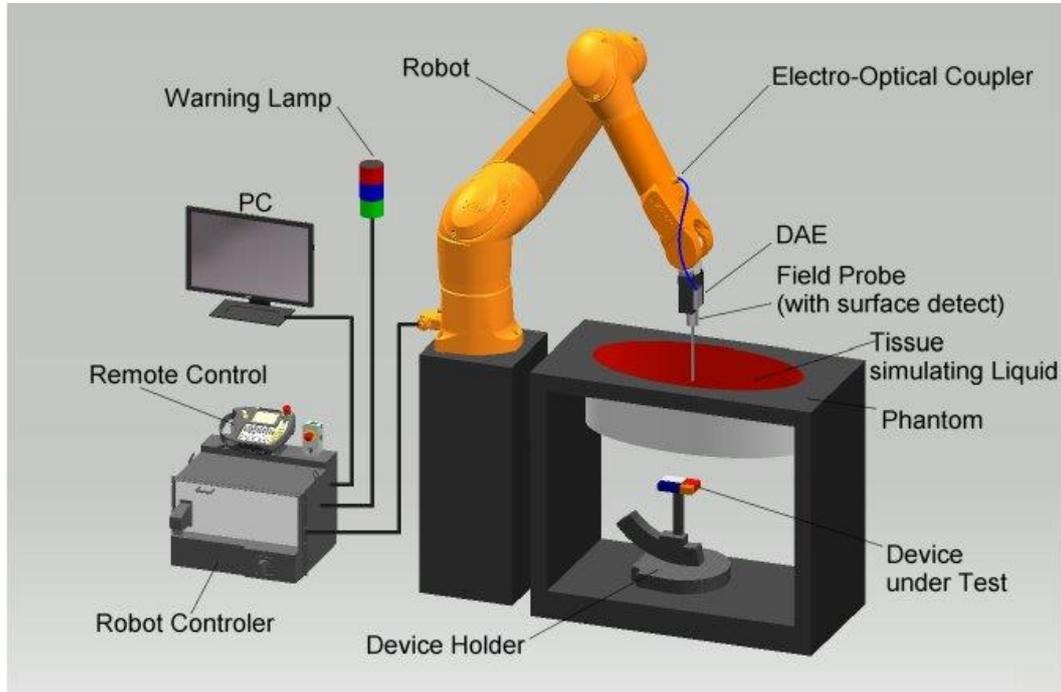
Le système DAS utilisé pour les essais de conformité comprend les éléments suivants :
