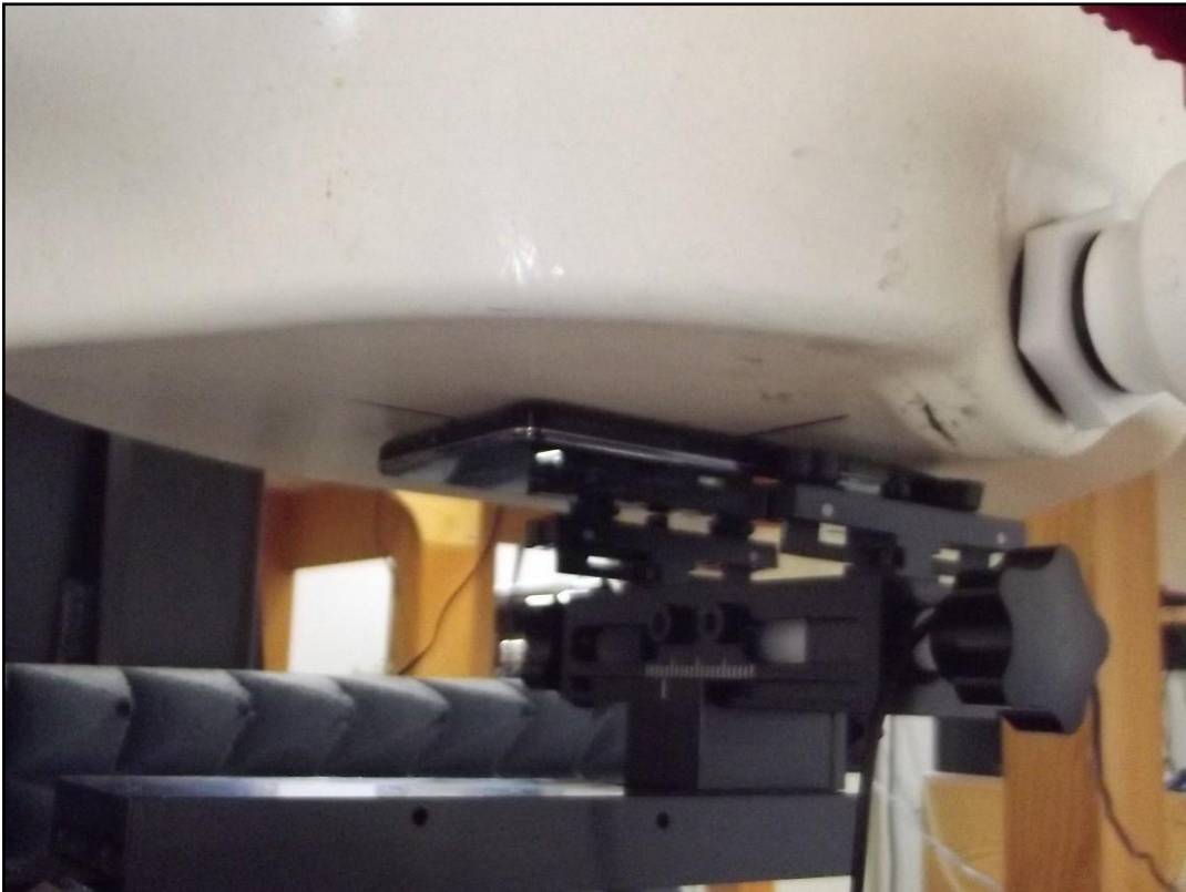
Photo 7: Position d'essai face arrière contre le corps (distance 0 mm)
