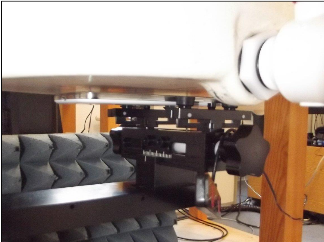
Photo 9: Position d'essai face avant contre le corps (distance 5 mm)
