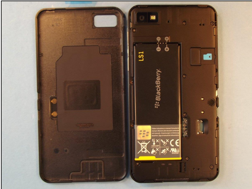
Photo 5: EST – vue arrière (ouvert) avec batterie
