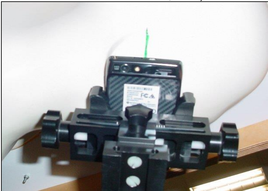
Photo 14: Position d'essai main droite, contre la joue
