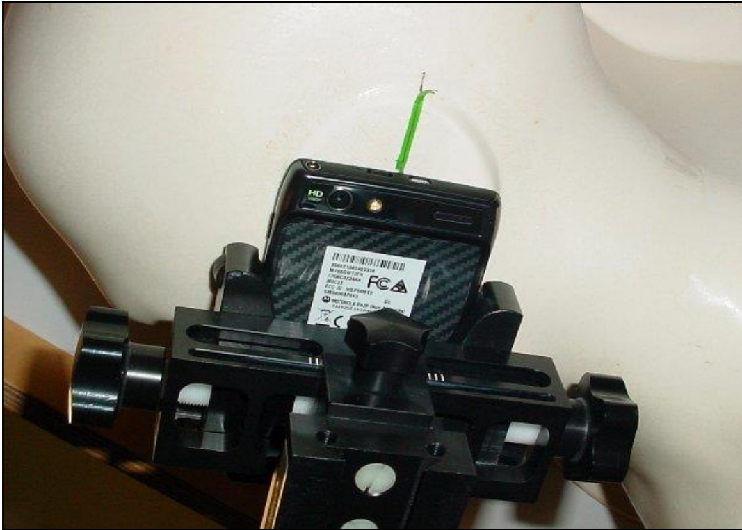
Photo 10: Position d'essai main gauche, incliné 15°
