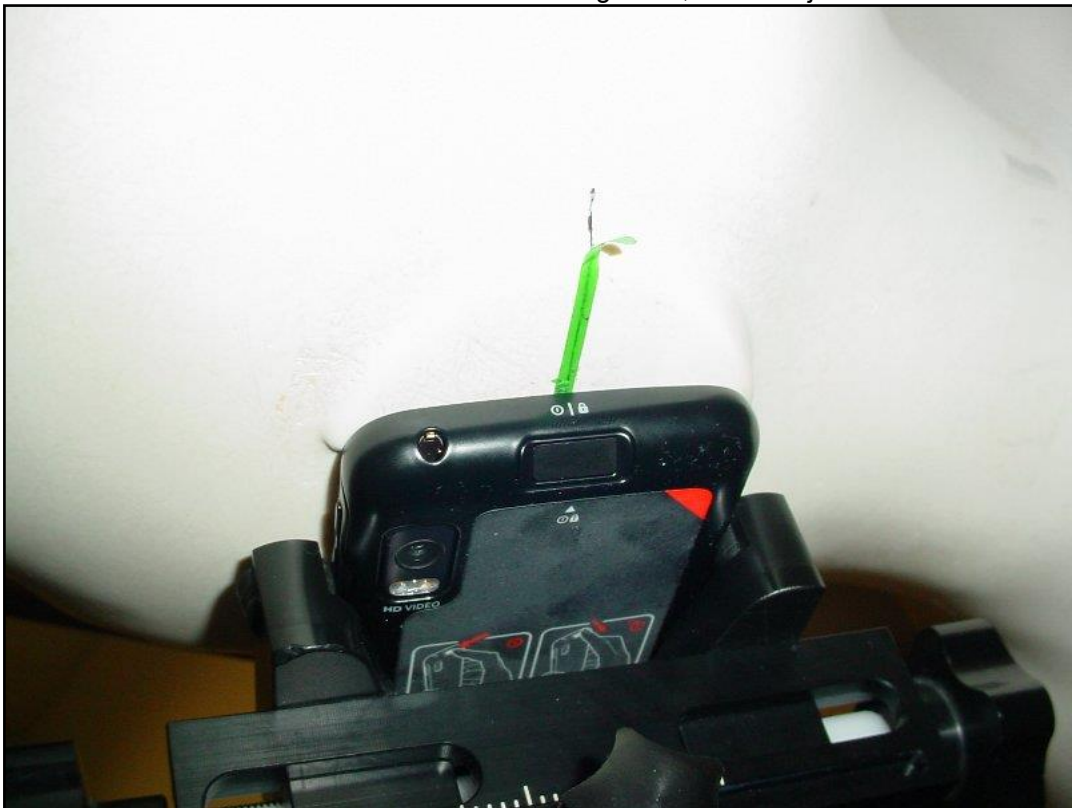
Photo 10: Position d'essai main gauche, contre la joue
