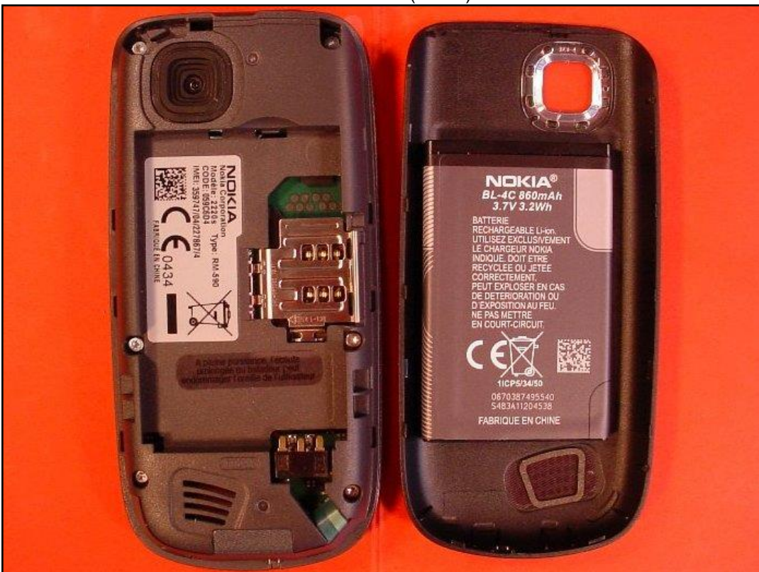
Photo 8: EST – vue arrière (ouvert) sans batterie
