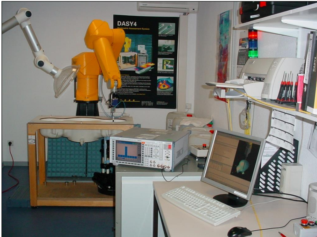
Photo 1: Banc d'essai DASY 4
