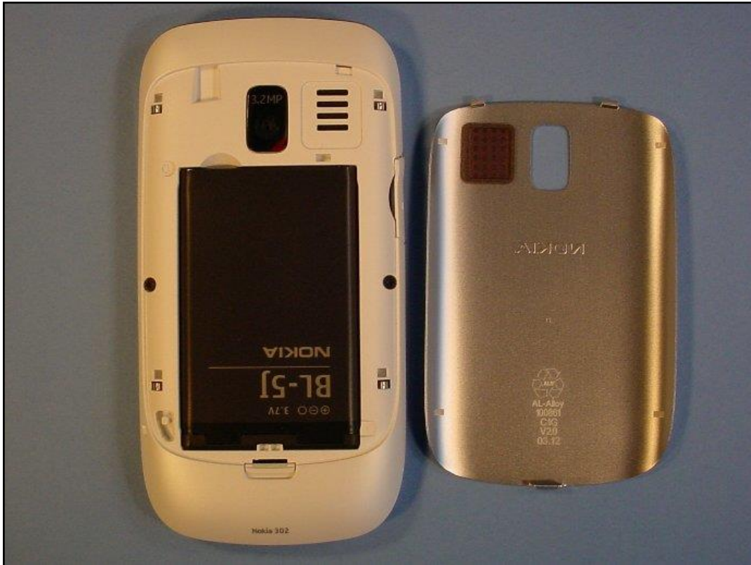
Photo 5: EST – vue arrière (ouvert) avec batterie
