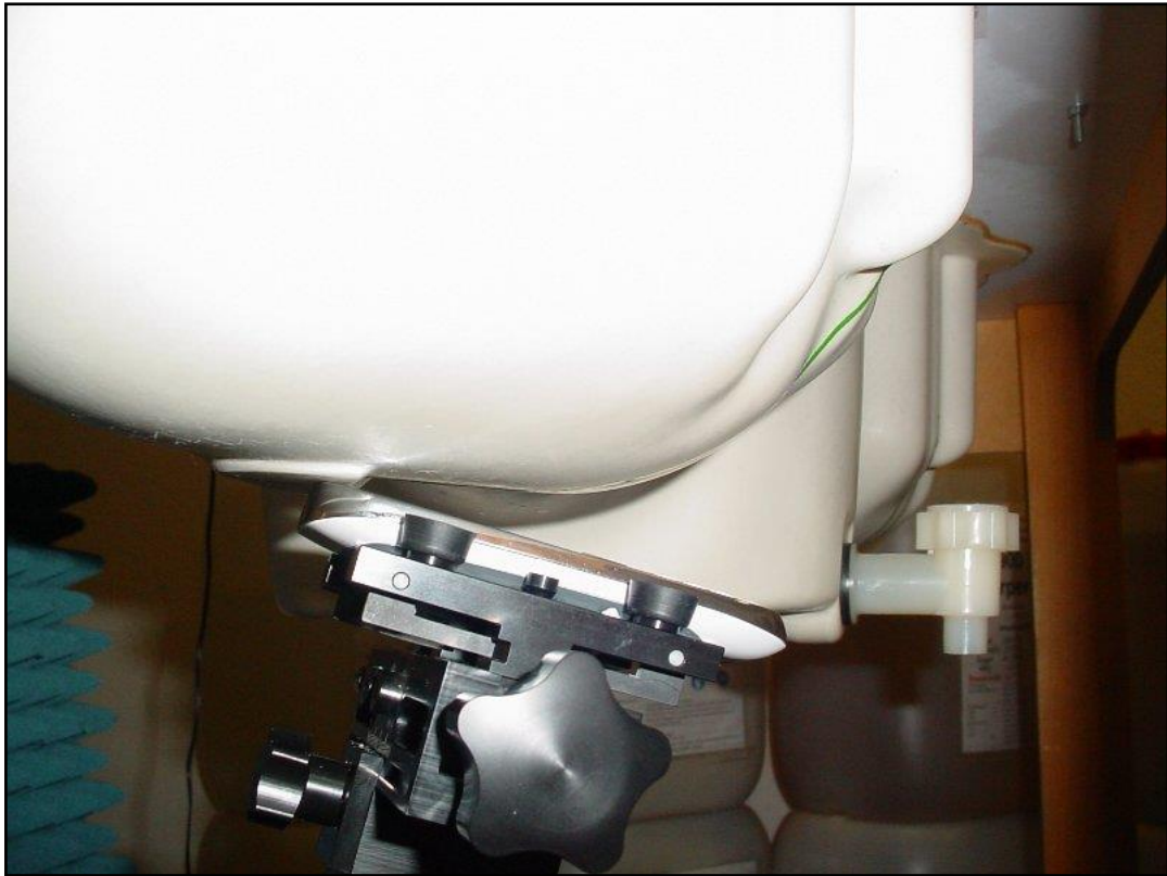
Photo 17: Position d'essai main droite, incliné 15°
