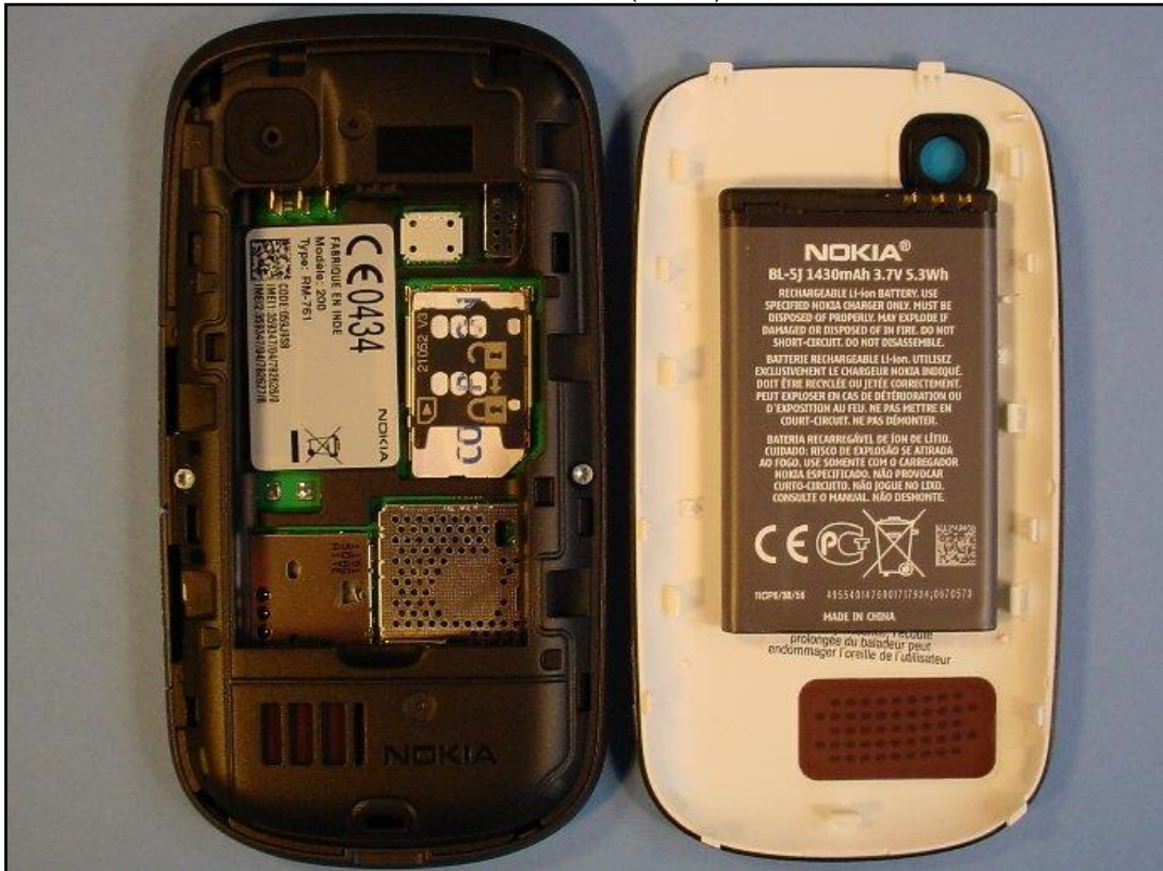
Photo 6: EST – vue arrière (ouvert) sans batterie
