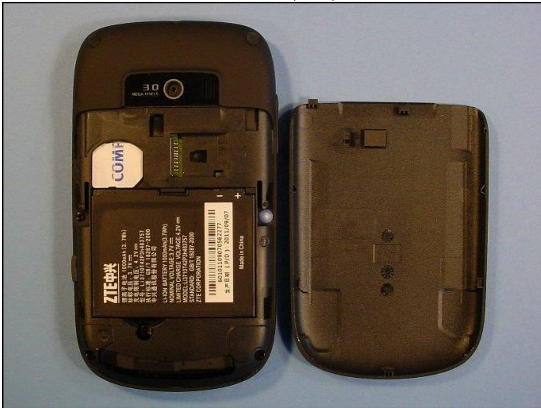
Photo 6: EST – vue arrière (ouvert) sans batterie
