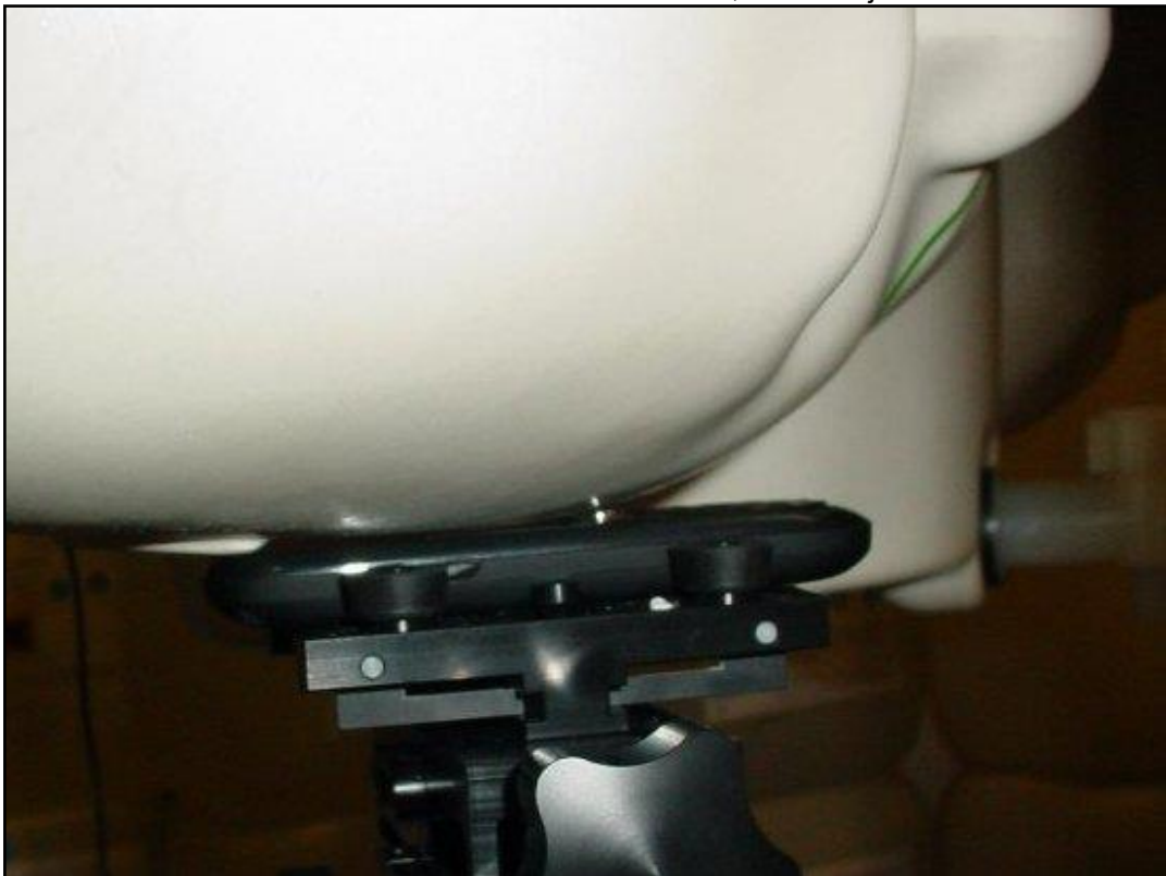
Photo 14: Position d'essai main droite, contre la joue
