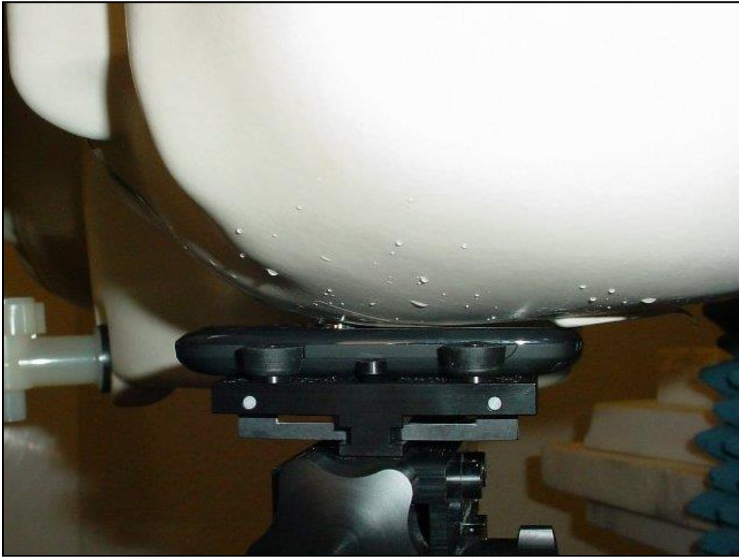
Photo 10: Position d'essai main gauche, contre la joue
