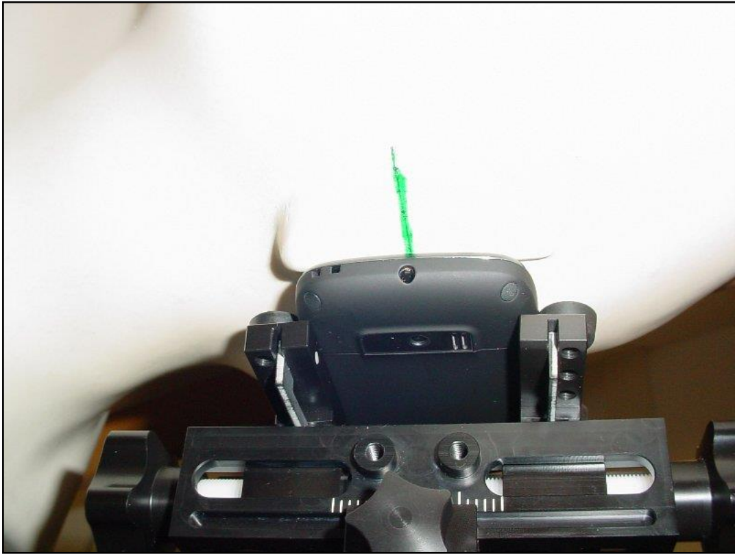
Photo 16: Position d'essai main droite, incliné 15°
