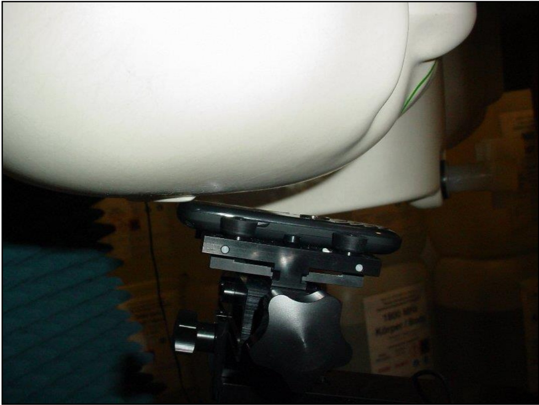
Photo 17: Position d'essai main droite, incliné 15°
