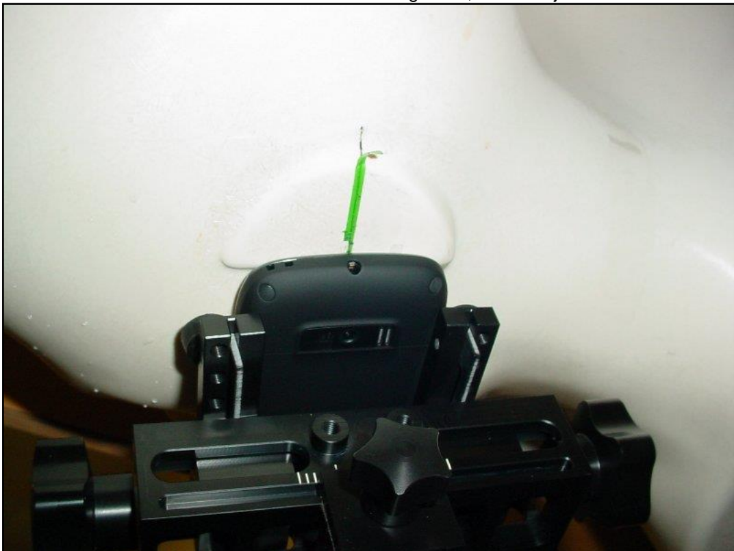
Photo 10: Position d'essai main gauche, contre la joue
