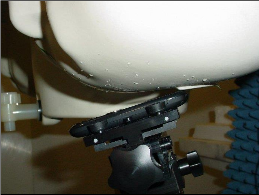
Photo 12: Position d'essai main gauche, incliné 15°
