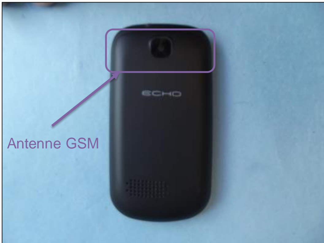
Photo 4: EST – vue arrière
