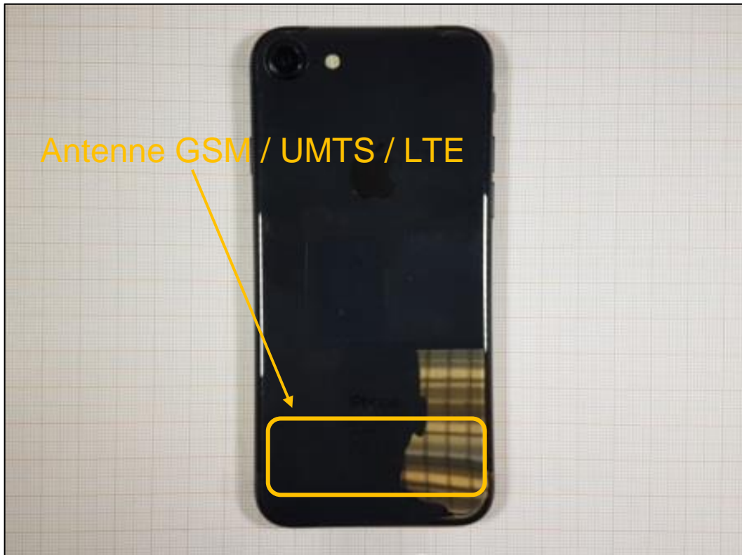
Photo 4: EST – vue arrière
