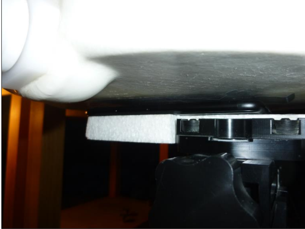
Fig. 15 : Face avant à 0.5cm du fantôme
