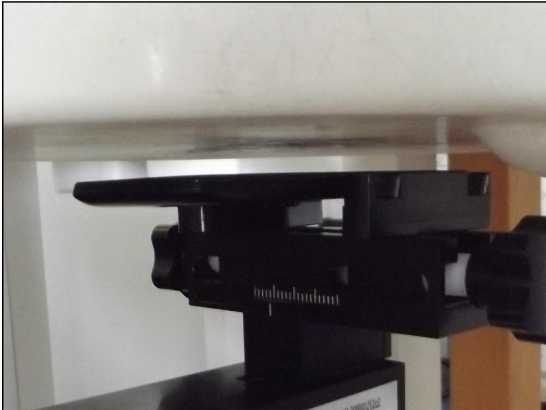
Photo 7: Position d'essai face avant contre le corps (distance 10 mm)
