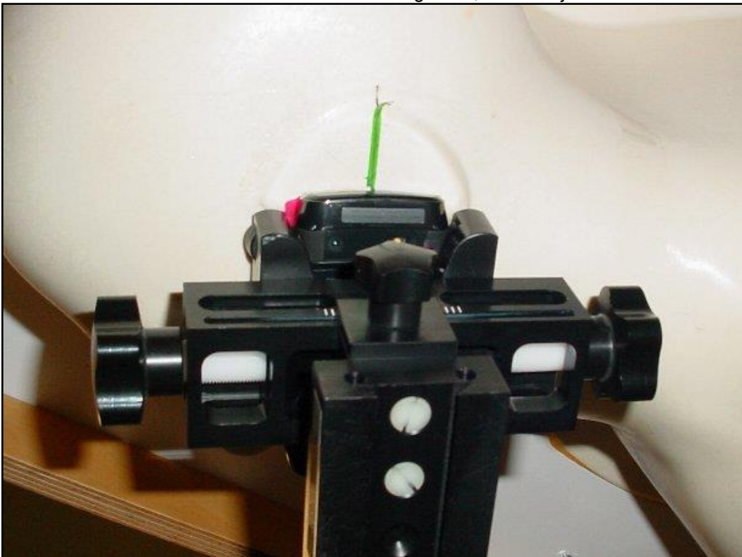
Photo 10: Position d'essai main gauche, contre la joue
