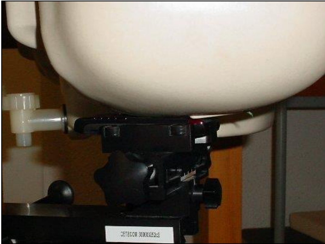
Photo 10: Position d'essai main gauche, contre la joue
