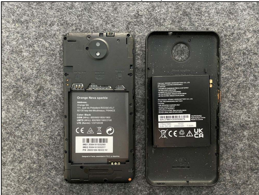
Photo 6: EST – vue arrière (ouvert) sans batterie
