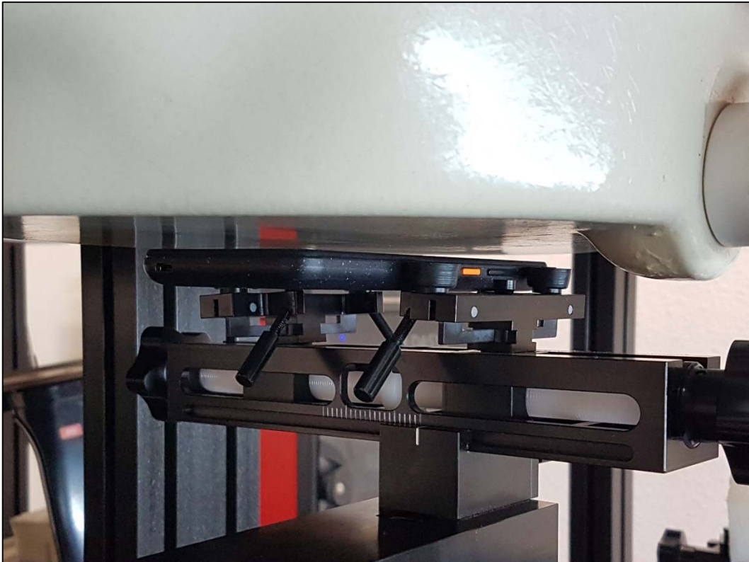
Photo 9: Position d'essai face arrière contre le corps (distance 5 mm)
