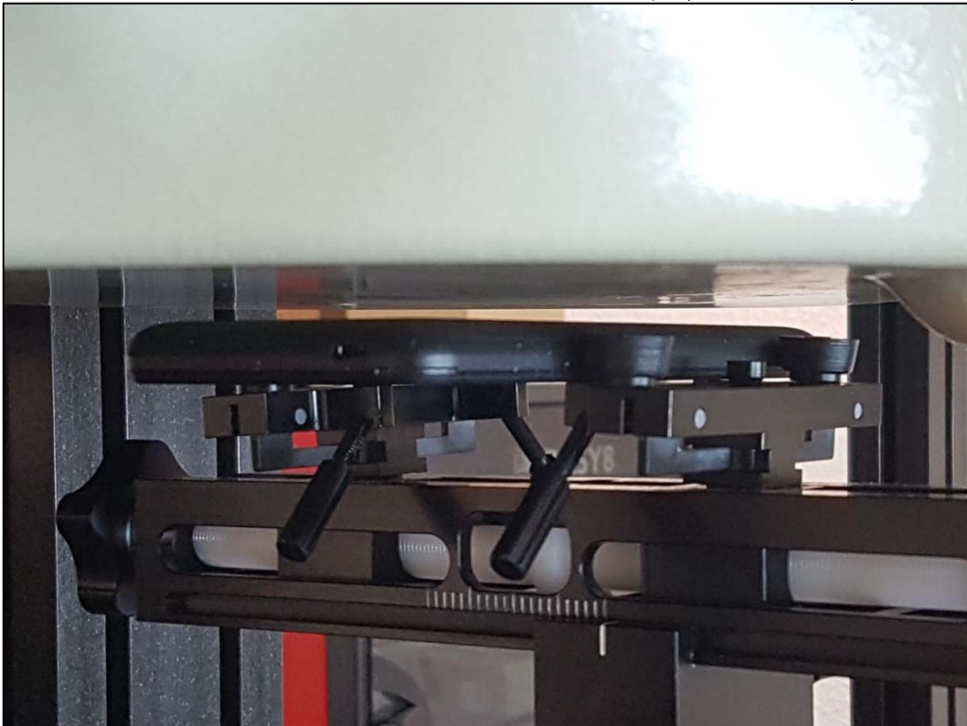
Photo 9: Position d'essai face arrière contre le corps (distance 5 mm)
