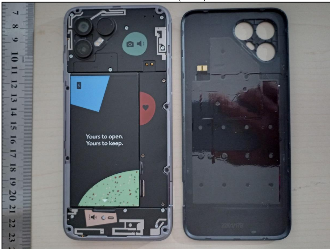
Photo 6: EST – vue arrière (ouvert) sans batterie
