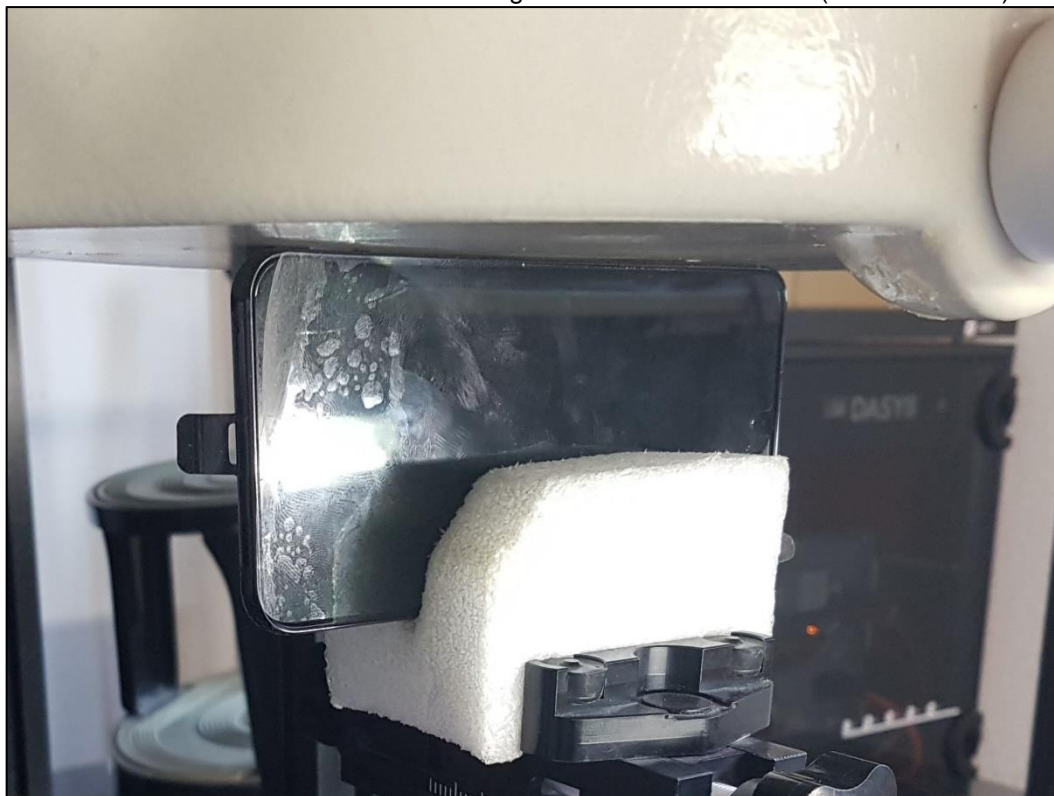
Photo 9: Position d'essai face du côté gauche contre le membre (distance 0 mm)
