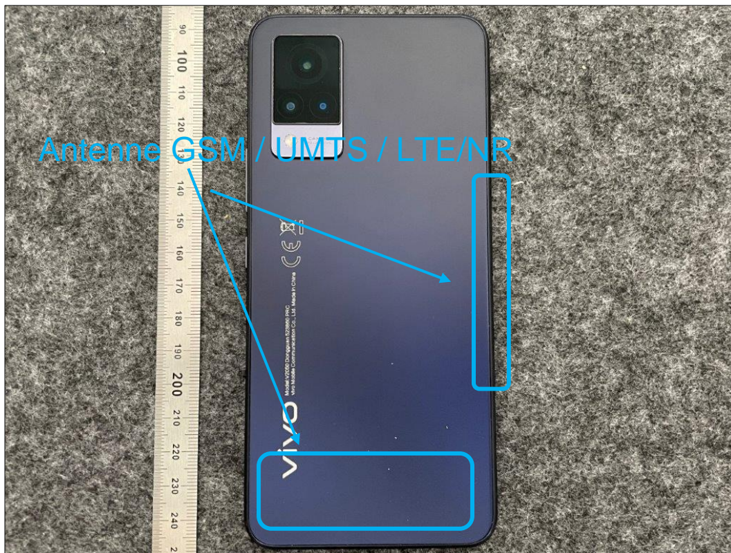
Photo 4: EST – vue arrière
